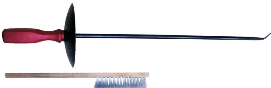
Exemple : Crochet à copeaux et brosse à copeaux
