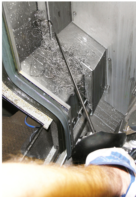
Beispiel: Entfernen der Spänenester mit Hilfe geeigneter Werkzeuge (z.B. Spänehooken)
